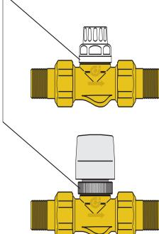
Per eventuali operazioni preliminari di apertura/chiusura, può essere utilizzata la manopola manuale di cui è fornita la valvola. La sua rimozione, per montare il comando eletrotermico, si effettua svitando la ghiera inferiore.
