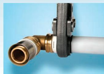
Dégager la mâchoire en appuyant simultanément sur les deux mors. Le raccord est serti.
