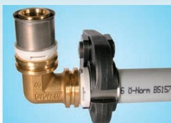
Positionner la mâchoire de serrage sur la douille en inox, puis enclencher l'interrupteur de l'appareil.
