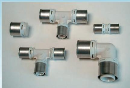
Le PPSU se caractérise par une très grande résistance aux chocs et à la rupture. En outre, il permet la réalisation de raccords extrêmement compacts et légers. Ces raccords sont disponibles jusqu'au DN63 pour les raccords correspondant à des pièces forgées (coudes, tés, manchons).
