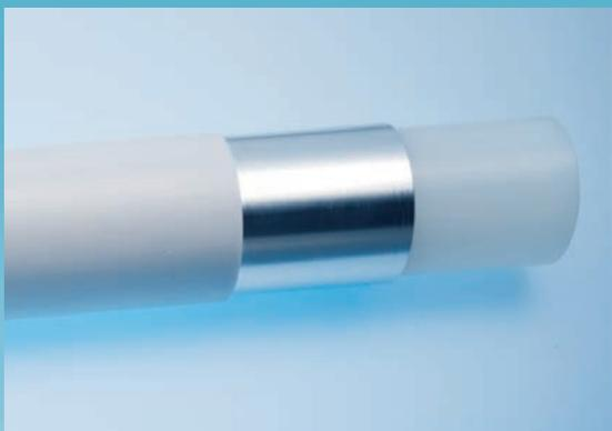
Cette combinaison de deux matériaux aussi différents que le **PER** et l'aluminium offre une originalité et des caractéristiques alliant les avantages des deux éléments. Notre tube est constitué d'un coeur en aluminium lié à deux couches interne et externe de **PER** extrudées simultanément.
