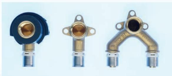
Nos sorties sont équipées d'une coque en mousse isolante pour réduire simultanément les émissions thermiques et phoniques. A la sortie simple s'est rajoutée une sortie double, quasi monotube sanitaire, dont l'intérêt est d'éviter deux alimentations distinctes lorsque deux points de puisage sont proches l'un de l'autre dans une même pièce (WC, machine à laver...).
