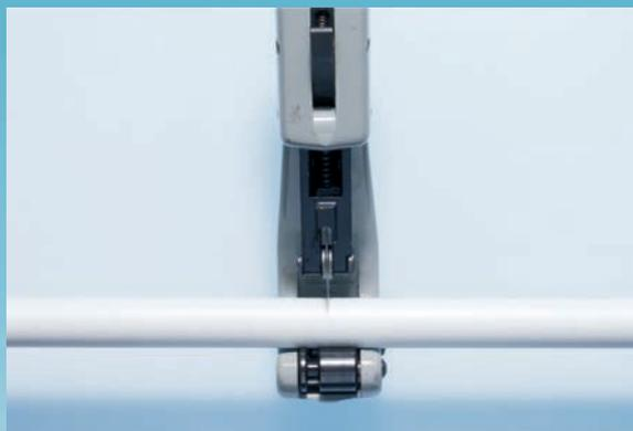
Couper le tube au moyen d'un coupe-tube afin d'obtenir une coupe franche, propre et perpendiculaire à l'axe de celui-ci.
