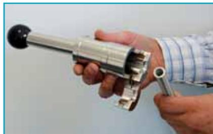
5 Retirer le tube : le collet battu est réalisé.
