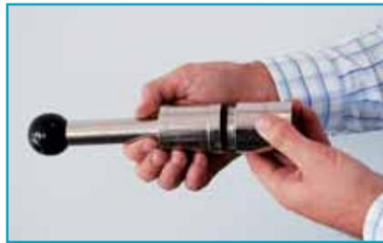
2 Choisir la tête d'outillage correspondant au diamètre du tube et visser sur le piston.
