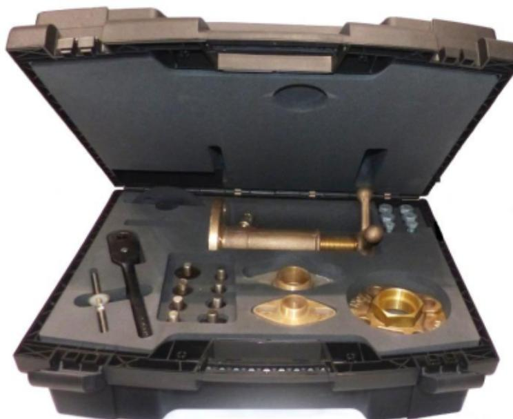
**Dimensions :** Pour perçage DN20 à DN40
