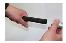
Amener en contact le joint torique du raccord avec la face de joint du robinet
