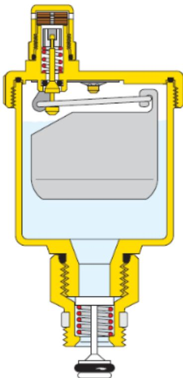
Le purgeur automatique permet d'éliminer l'air emprisonné dans les installations de chauffage et de climatisation sans devoir intervenir manuellement. On évite ainsi les effets indésirables comme le bruit, la cavitation des pompes, l'usure des appareils présents sur les circuits et le mauvais rendement des corps de chauffe.
