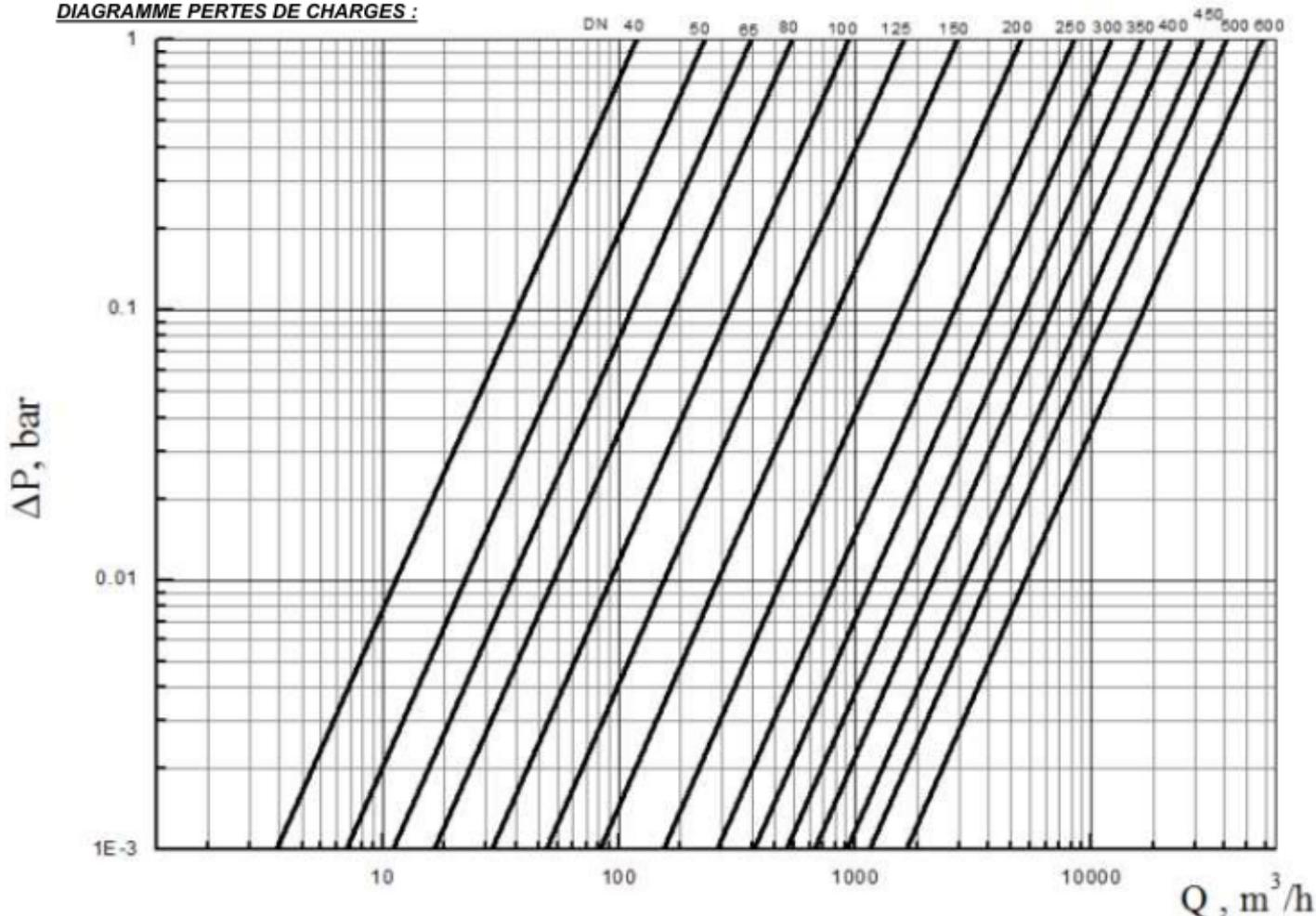
**VANNE A OPERCULE CAOUTCHOUC PN10/16 DIN LONG 3202-F5 FSH**
