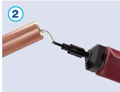
2 Retirer les imperfections et chanfreiner l'extrémité du tube cuivre. Calibrer le tube cuivre si celui-ci a été déformé durant la coupe.
