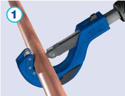
1 Couper le tube cuivre à la longueur souhaitée, à angle droit, à l'aide d'un coupe-tube adapté
