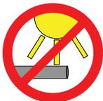
Les tubes composites multicouches Wavin doivent être protégés contre le rayonnement direct et intensif du soleil et contre toute autre source de rayons UV.
