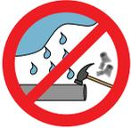
Les composants des systèmes Wavin sont bien protégés par leur emballage d'origine. Tous les composants (raccords et tubes) doivent toutefois être protégés contre les dommages et dégradations liés aux intempéries.
