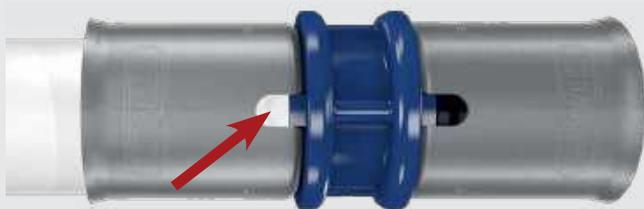
Un regard dans la bague à sertir en acier inoxydable permet de contrôler que le tube est inséré jusqu'en butée.
