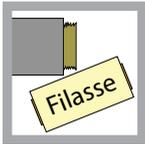
L'assemblage d'un raccord fileté doit être réalisé conformément aux règles de l'art. Nous recommandons l'utilisation de filasse de chanvre et d'une pâte à joint autorisée. La filasse doit être appliquée en faible quantité, de sorte à laisser apparentes les arêtes du
