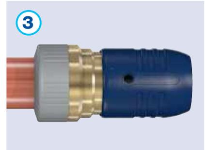
3 Contrôler la propreté du raccord de transition ainsi que le bon positionnement du joint et de la bague de crampage. Insérer le tube cuivre dans le raccord aussi loin que possible. La force d'insertion augmente lorsque la bague de crampage vient au contact du tube. Ne pas utiliser de lubrifiant pour cette opération.
