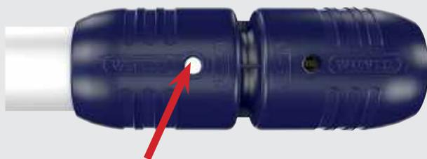
Un regard dans le capuchon permet de contrôler que le tube est inséré jusqu'en butée.
